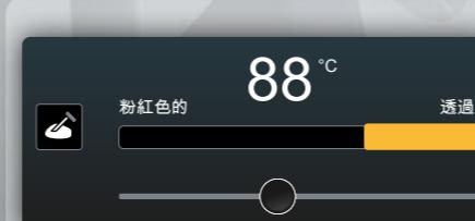
整合核心溫度感測器透過六個測量點偵測產品大小和數量。這樣，就可以準確地達到所選的核心溫度並保證所需的結果。下次也以同樣的方式準備。
